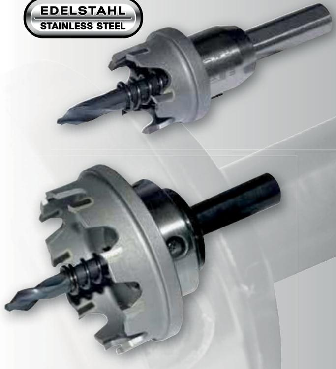
Der Einsatzbereich von Hartmetall-Lochsägen unterscheidet sich von HSS-Bi-Metall Lochsägen. Mit ALFRA hartmetallbestückten Lochsägen können wirtschaftlich Edelstahl bis 2 mm ( $\frac{1}{16}$ " ), unlegierte Stähle bis 4 mm ( $\frac{3}{16}$ " ), Kunststoffe, PVC, Aluminium, Zink, Gips und Leichtbauplatten u. a. verarbeitet werden. Zum Einsatz für Hand- und Säulenbohrmaschinen. Bei Säulenbohrmaschinen kein automatischer Vorschub.
